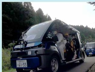
自動運転は遊歩道として整備された道に設置された電磁誘導線の磁力線を感じて運行されます。実験では、安全のためドライバーが同乗しましたが、運転はシステムが行いました。
